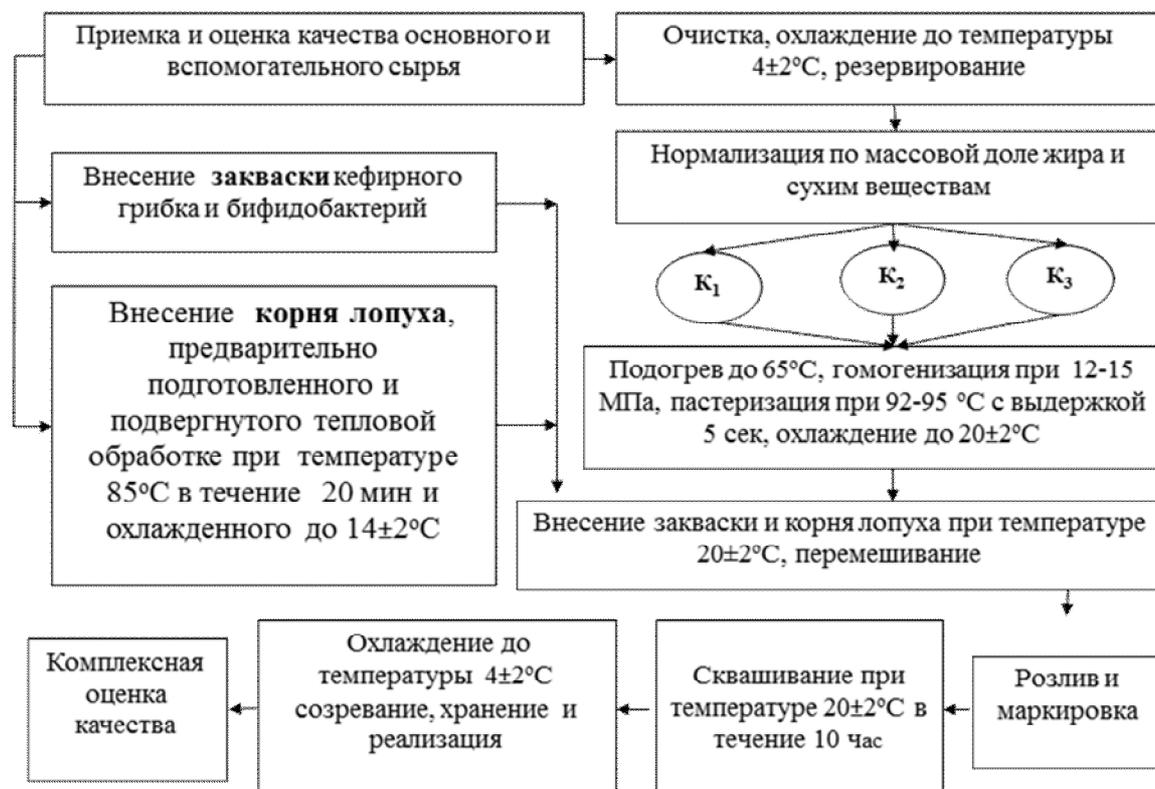
Рисунок 2 - Технологическая схема производства биокефирных продуктов, обогащенных корнем лопуха.
