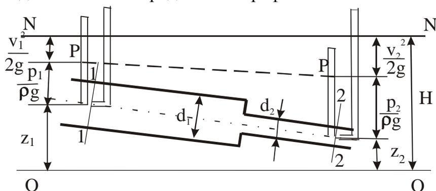
Рис. 14 - Графическое изображение уравнения Бернулли для идеальной жидкости
