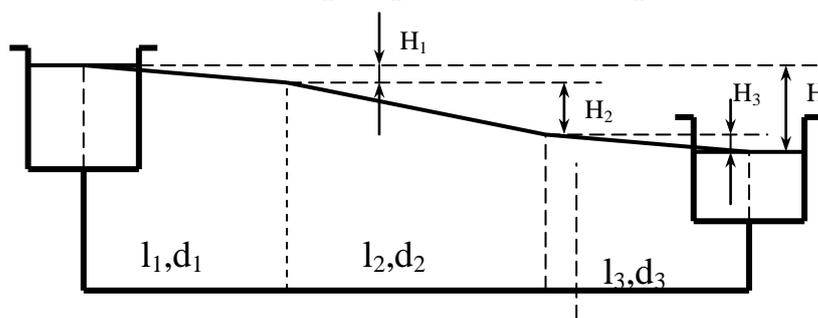
Рис. 24 – Длинный трубопровод с последовательным соединением труб
