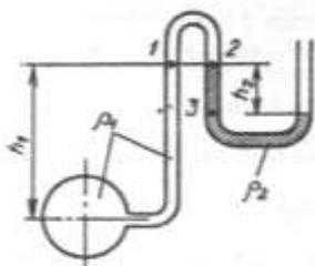
2.3. Жидкость плотностью  $\rho_1$  находится в равновесии в сосуде, к которому подключен прибор для измерения давления. Его левая трубка заполнена жидкостью. Рабочая жидкость в U-образной трубке имеет плотность  $\rho_2$ . Граница раздела жидкостей находится выше центра сосуда на высоте  $h_1 = 0,4$  м, разность уровней рабочей жидкости  $h_2 = 0,1$ . Определить манометрическое да-
