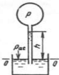
2.6. В баллоне с воздухом давление  $p$  меньше атмосферного. Присоединенная к баллону трубка опущена в сосуд с водой. Под действием атмосферного давления жидкость поднимается в трубке на высоту  $h$ . Определить на какую высоту поднимется вода, если  $p = 90,2 \text{ кПа}$ .
