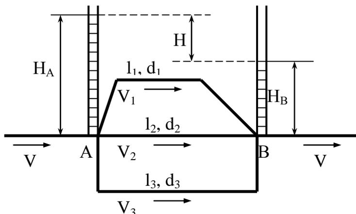
Рис. 25 – Длинный трубопровод с параллельным соединением труб
