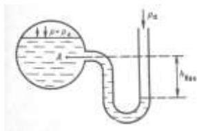
2.11. Определить высоту на которую опустится уровень воды в вакуумметре, присоединенном к баллону, давление на поверхности жидкости в котором  $p_0 = 96 \text{ кПа}$ , точка А погружена на глубину 0,3 м.
