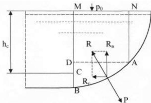
Рис. 12 – Силы, действующие на криволинейную поверхность
