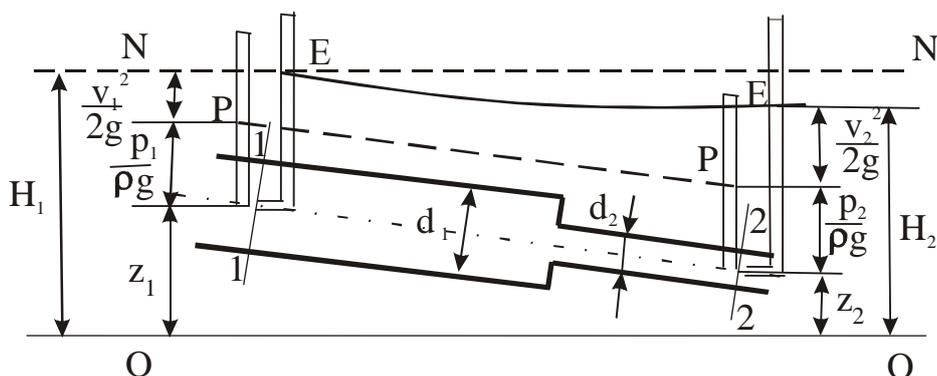
Рис. 15 - Графическое изображение уравнения Бернулли
