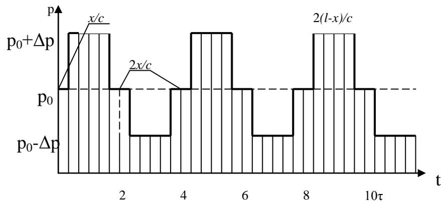
Рис. 28 – Изменение давления на расстоянии  $x = 0,5l$  от задвижки
