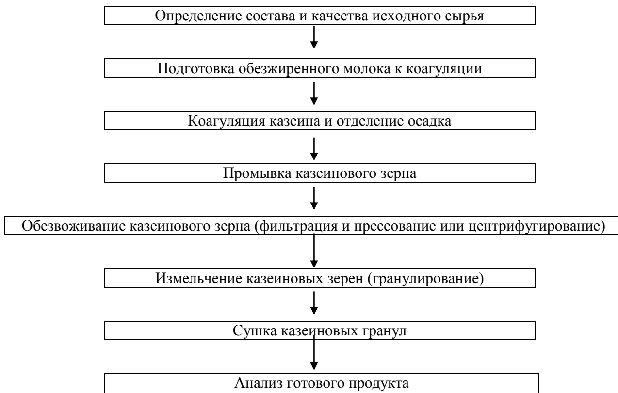
Рисунок 7 - Блок-схема алгоритма технологического процесса выработки казеина.
