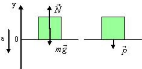
$$ma = mg - N \text{ - второй закон Ньютона}$$
