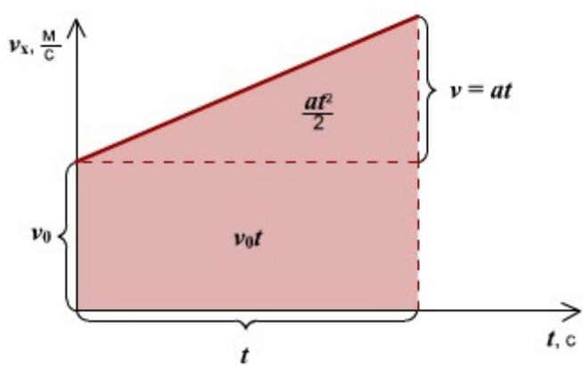
*Правило определения ускорения по графику  $v(t)$ :* Ускорение тела - это тангенс угла наклона графика к оси времени. Если тело замедляет движение, ускорение отрицательное, угол графика тупой, поэтому находим тангенс смежного угла.
