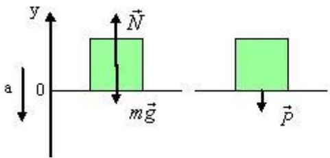
$$ma = mg - N \text{ - второй закон Ньютона}$$
