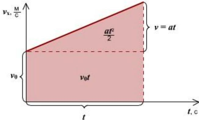
*Правило определения ускорения по графику  $v(t)$ : Ускорение тела - это тангенс угла наклона графика к оси времени. Если тело замедляет движение, ускорение отрицательное, угол графика тупой, поэтому находим тангенс смежного угла.*
