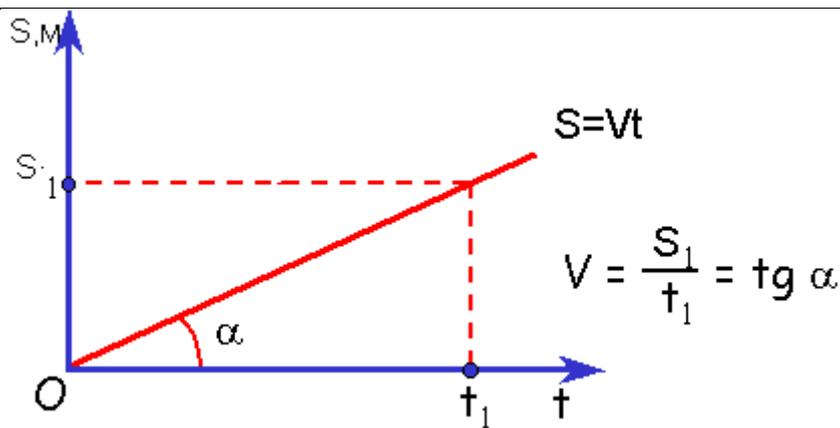
Зависимость координаты от времени. График  $x(t)$  - наклонная линия:
